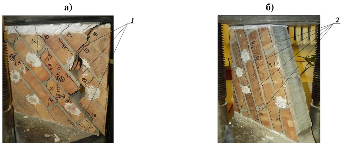
«1» – раскалывание по зигзагообразной траектории по границе контакта камней и растворных швов; «2» – сдвиг вдоль горизонтальных растворных швов а) – \theta = 45^\circ ; б) – \theta = 67,5^\circ
