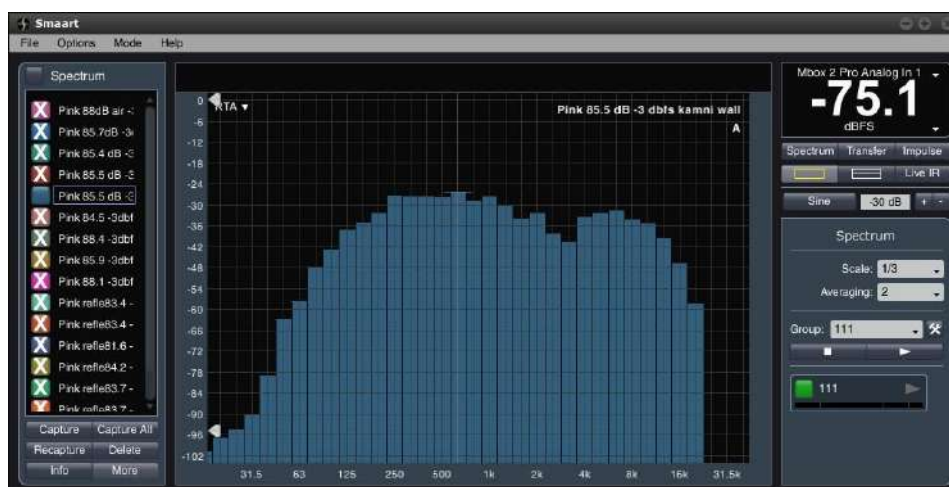
Рисунок 9 – Спектр отраженного звука от рифленой поверхности образца
