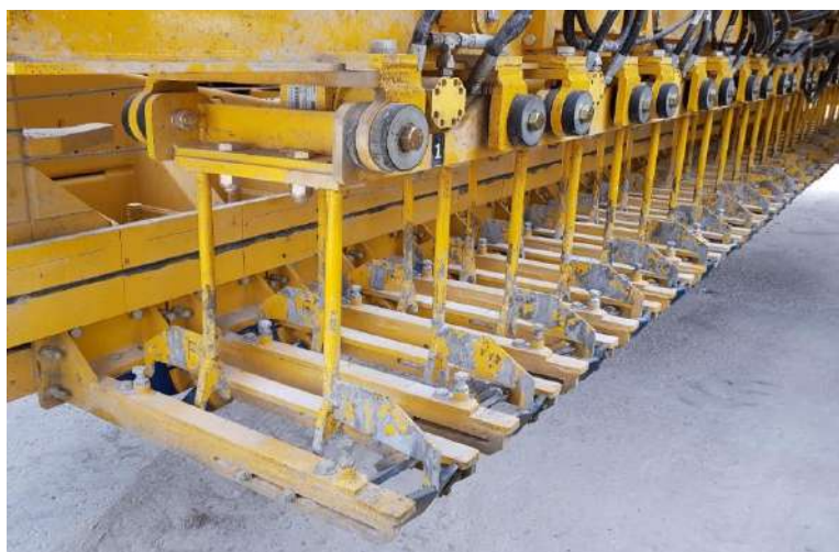
Рисунок 11 – Вилки для вибропогружения дюбелей
